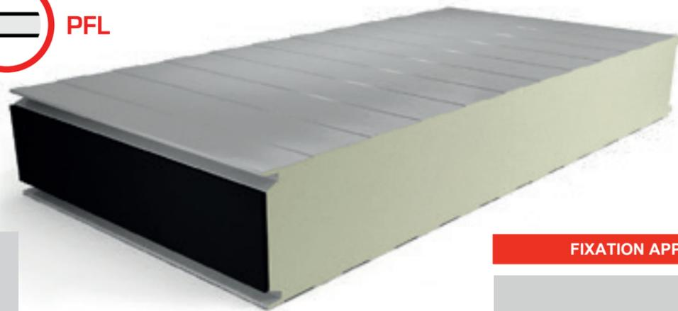
Les panneaux se démarquent par leur haut niveau d'isolation atteint grâce aux épaisseurs de l'âme en polyuréthane (150-200 mm) et à la particulière technologie du joint. La forme du joint s'avère particulièrement adaptée à l'étanchéité mécanique et thermique et permet aussi le logement du produit d'étanchéité pour une meilleure étanchéité à l'air.
